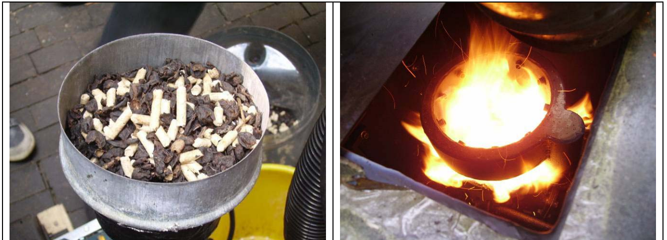
Abbildung 11: Getrocknete Kaffeepulve brennt in einem Pelletbrenner ohne mechanische Durchmischung nur durch Beimischen einer Zündquelle zufrieden stellend. Im Versuch wurden 50 Gew.-% Pellet beigemischt.
