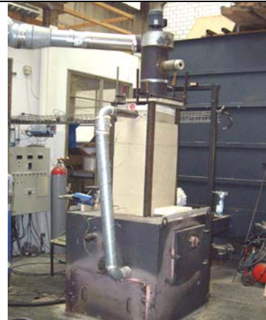
Abbildung 4: Fertig aufgebauter Prototyp des Pulpebrenner (im unteren Teil die Brennkammer, im oberen Teil anschliessend der Rekuperator)
